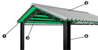
1- TERMOFOAM® 2- Lámina galvanizada. 3- Viga al centro.
