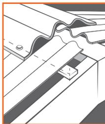
Con la lámina PolyLit podemos obtener cumbreiras de dos o tres ondas fijando a los apoyos de la lámina.
