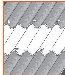
PolyLit se puede traslapar con lámina opaca Opalit, (también de Stabiliit) para permitir el paso de la luz al interior y ahorrar energía eléctrica.
